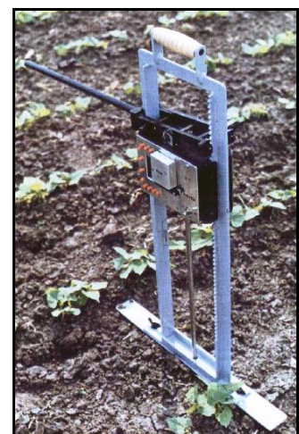
Fig. 3. Hand penetrometer 3. ábra. Kézi penetrométer
